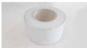
21NS09PLUS - Cinta de aluminio con tratamiento autolimpiante Cinta en aluminio autoadhesivo con tratamiento autolimpiante empleada en la unión de fajas de panel (lado interior del ducto) en la línea careplus. La cinta viene en rollos de 50 metros y en paquetes de 4 rollos.
